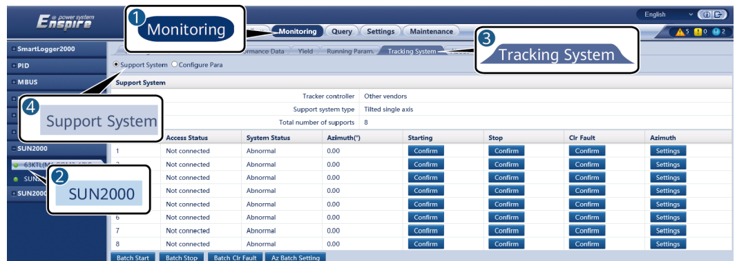
Figura 6-50 Sistema de suporte (sistema de rastreamento)
