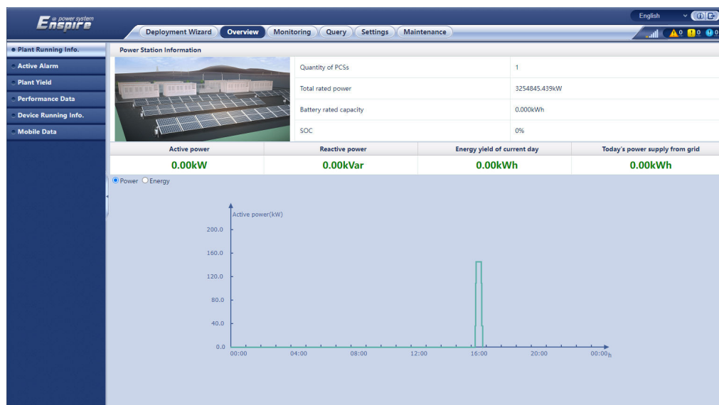
Figura 6-4 Informações de funcionamento da central (com bateria, mas sem medidor de energia)
