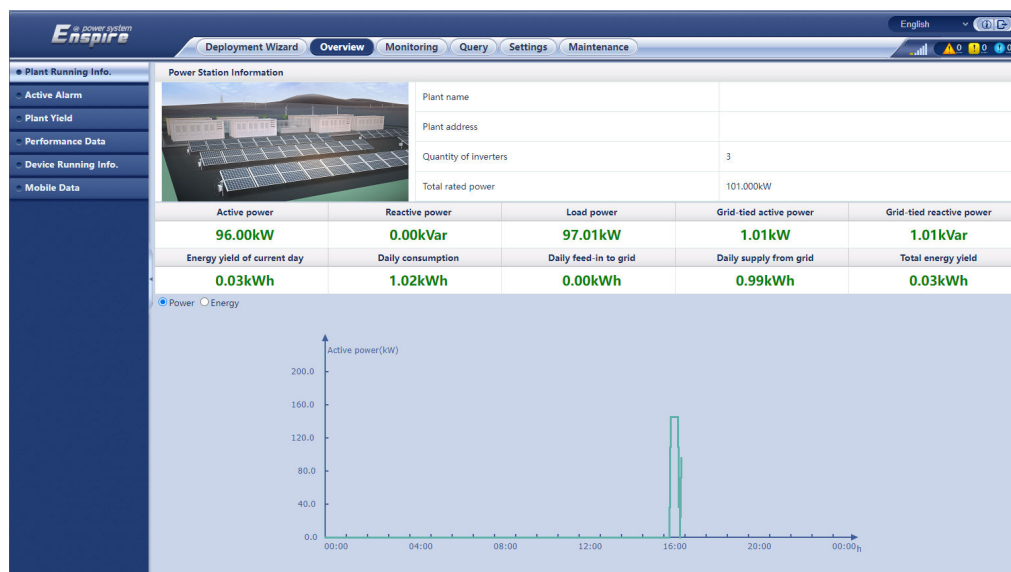
Figura 6-3 Informações de funcionamento da central (com medidor de energia, mas sem bateria)
