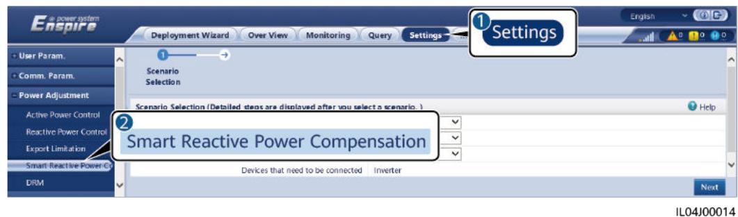
Figura 6-84 Configuração dos parâmetros de compensação de potência reativa inteligente (seleção de cenário)
